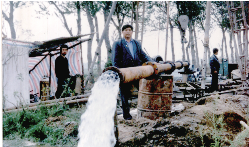
东阿下马头水源地勘探抽水试验场景（作者供图）
