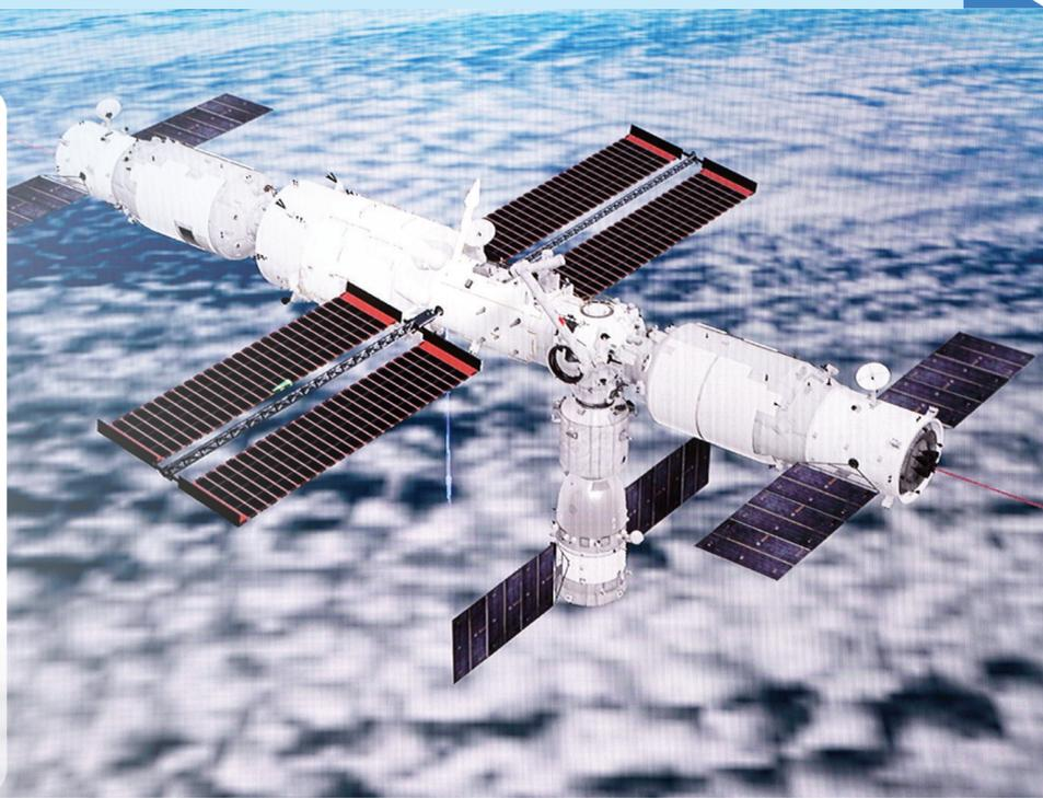
1月6日凌晨,机械臂成功捕获天舟二号货运飞船。6时12分转位试验开始,天舟二号货运飞船与天和核心舱解锁分离后,在机械臂拖动下以核心舱节点舱球心为圆心进行平面转位;尔后,反向操作,直至货运飞船与核心舱重新对接并完成锁紧。
