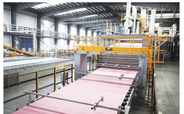
2月11日,信发集团新型环保建材产业园,采用国际先进技术的全程自动化生产线正在生产纸面石膏板。信发集团加快新旧动能转换,大力发展循环经济,将脱硫石膏等固废变成新型环保建材产品,纸面石膏板项目全部建成投产后,年可生产纸面石膏板2.4亿平方米。■ 本报记者 薛蓓蓓
