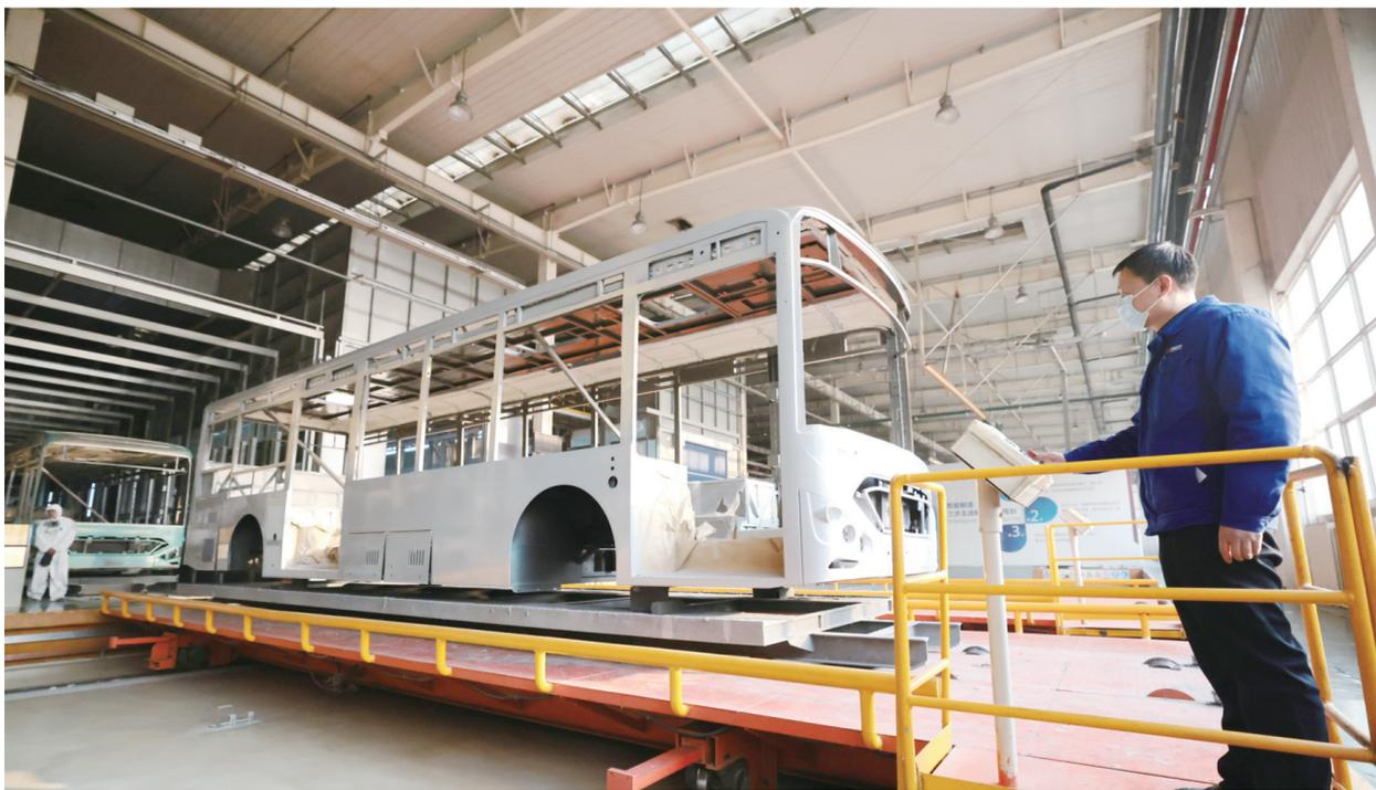
3月31日,在中通客车股份有限公司涂装车间,工作人员在用平移车调运涂装车辆。该公司使用自动喷涂机器人,实现了12.5米及以下主推车型喷涂轨迹覆盖率达到82.8%,人工操作时间可减少39%,有效提升了车辆涂装精细化管控能力。 ■ 本报记者 许金松
