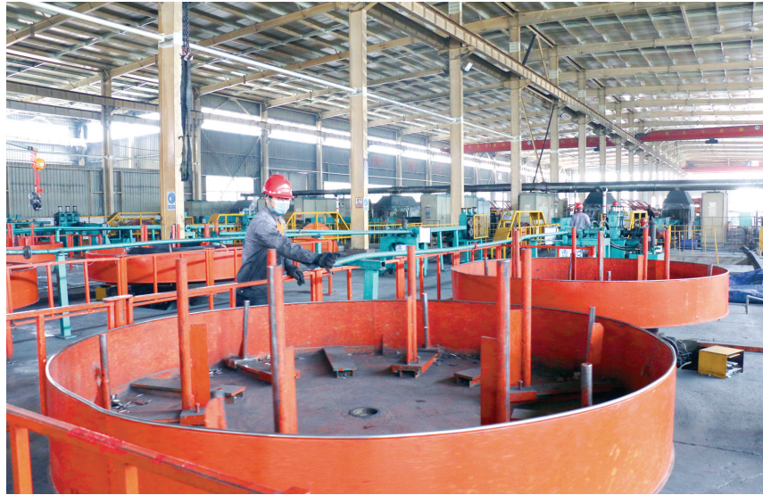
4 月 6 日,东昌府区鑫大地控股集团有限公司车间工作人员在查看预应力钢丝生产线运行情况。 该公司生产的预应力钢丝广泛应用于高铁、民航、电力、通信和高层抗震等领域。 ■ 本报记者 薛蓓蓓
