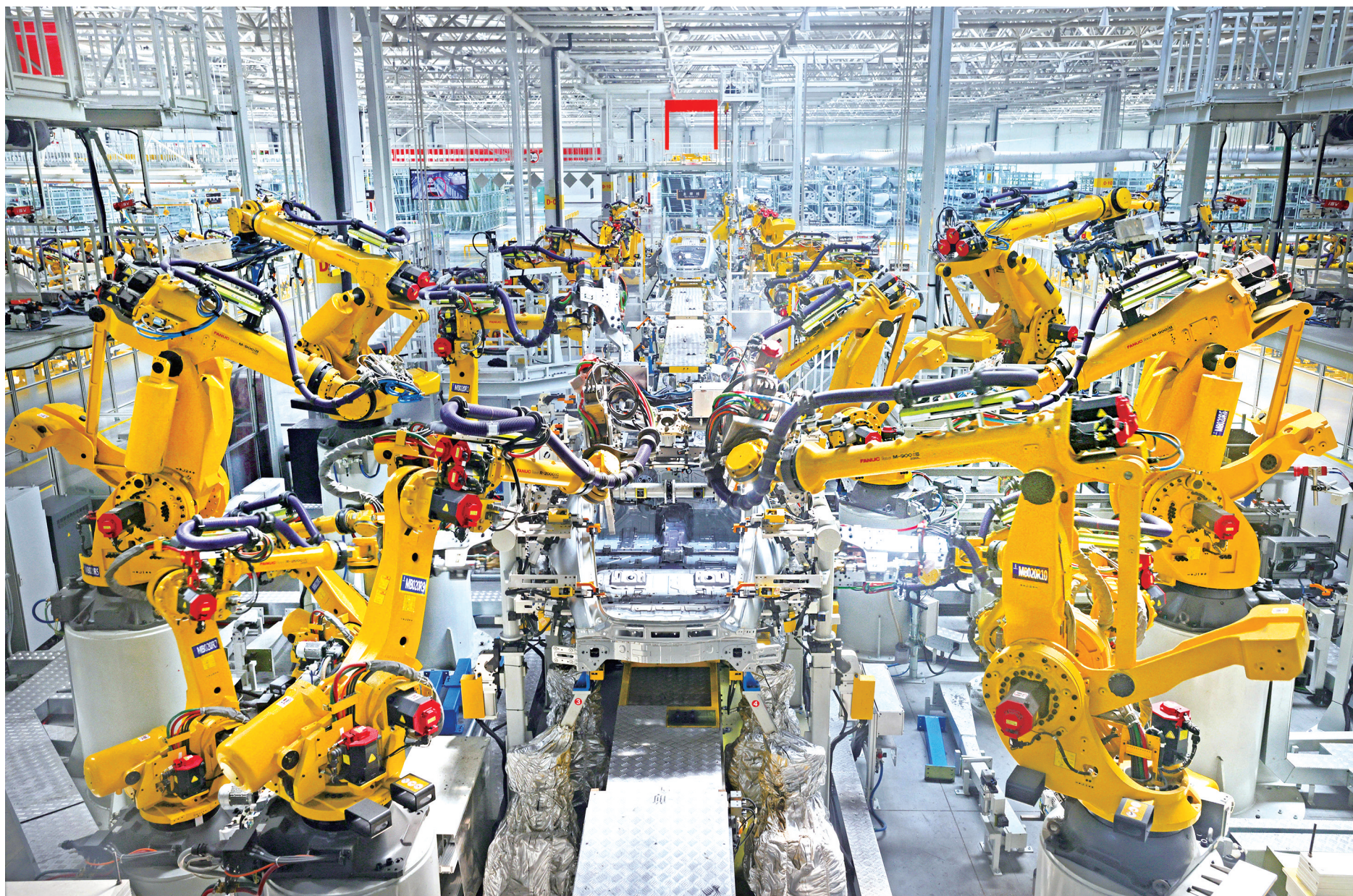
魏牌汽车有限公司汽车焊装车间,智能机器人进行焊接作业
