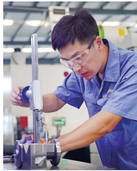
对汽车零部件进行质量检测 金马工业集团生产车间,工作人员
