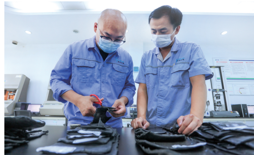
8月6日,在山东阳谷华泰化工股份有限公司,工作人员在裁切硫化胶片,准备进行测试。该公司拥有由科技部批准组建的国家橡胶助剂工程技术研究中心,项目建成投产后,将成为具有研发能力的创新型企业。 ■ 田柏林
