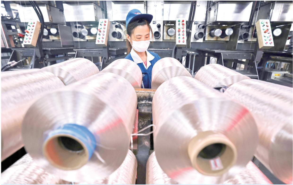
8月22日,在高唐时风化纤产业园聚纺车间,工作人员正在码放锦纶工业丝。该公司聚合纺丝生产线采用德国巴马格制造的高速卷绕机设备,转速快、效率高、运行噪音低,在全球锦纶纺丝及卷绕设备领域处于领先地位。时风化纤产业园目前是长江以北最大的锦纶化纤生产基地,锦纶工业丝的产能位居全国同行业首位。
