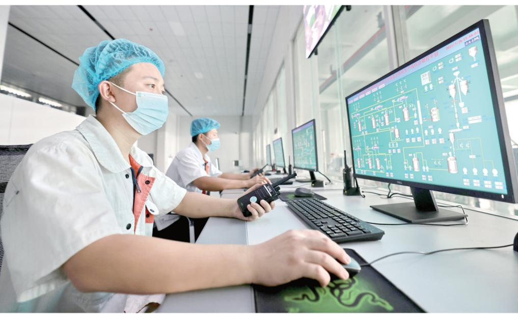
9月5日,在高唐宏生生物科技有限公司,工作人员通过大豆分离蛋白智能生产综合管控平台,对生产设备进行远程智能调节。该公司1万吨高端大豆蛋白生产线于今年6月正式投产,核心设备采用世界领先水平的德国、日本进口设备,产能提高12%,能耗降低20%,并通过智能控制,有效节省了人工成本。
