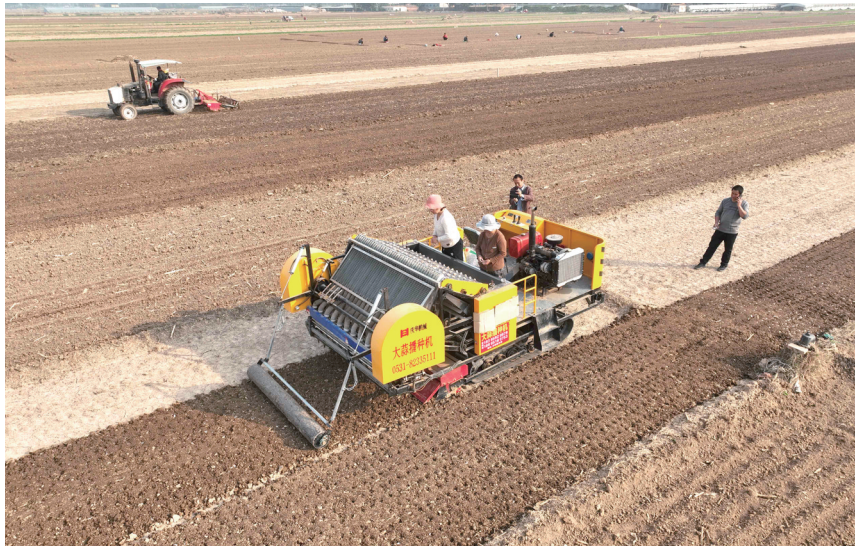
10月14日,在东昌府区沙镇齐楼村,一台履带式无人驾驶大疆播种机在田间作业。该播种机集旋耕、播种、覆土、整平等功能于一体,每小时可播种1.5亩左右,效率是人工的60多倍。
