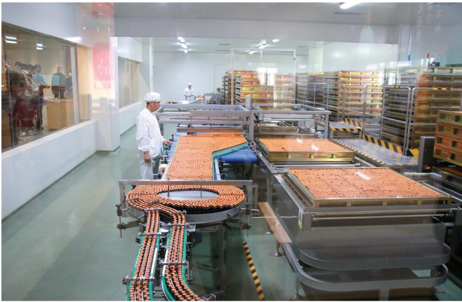
11月16日,东阿阿胶股份有限公司的复方阿胶浆全自动生产线正在高效有序作业。该生产线由上瓶、洗瓶、烘干、灌装、灭菌、灯检等10个工序组成,其中上瓶工序引入全自动机器人灭菌工序,包装工序建立“一盒一码”全过程追溯的药品码系统,为消费者健康安全提供保障。
