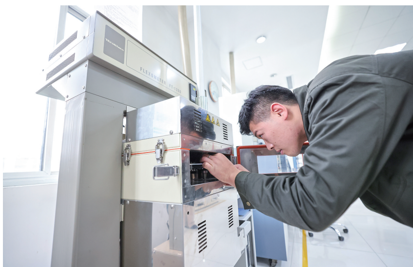
12 月 7 日,山东阳谷华泰化工股份有限公司工作人员在操作动态压缩生热试验机,进行压缩生热测试。作为首批国家高新技术企业,该公司已获授权专利 93 件,其中发明专利 56 件,计划打造行业内首个五型智能工厂。
