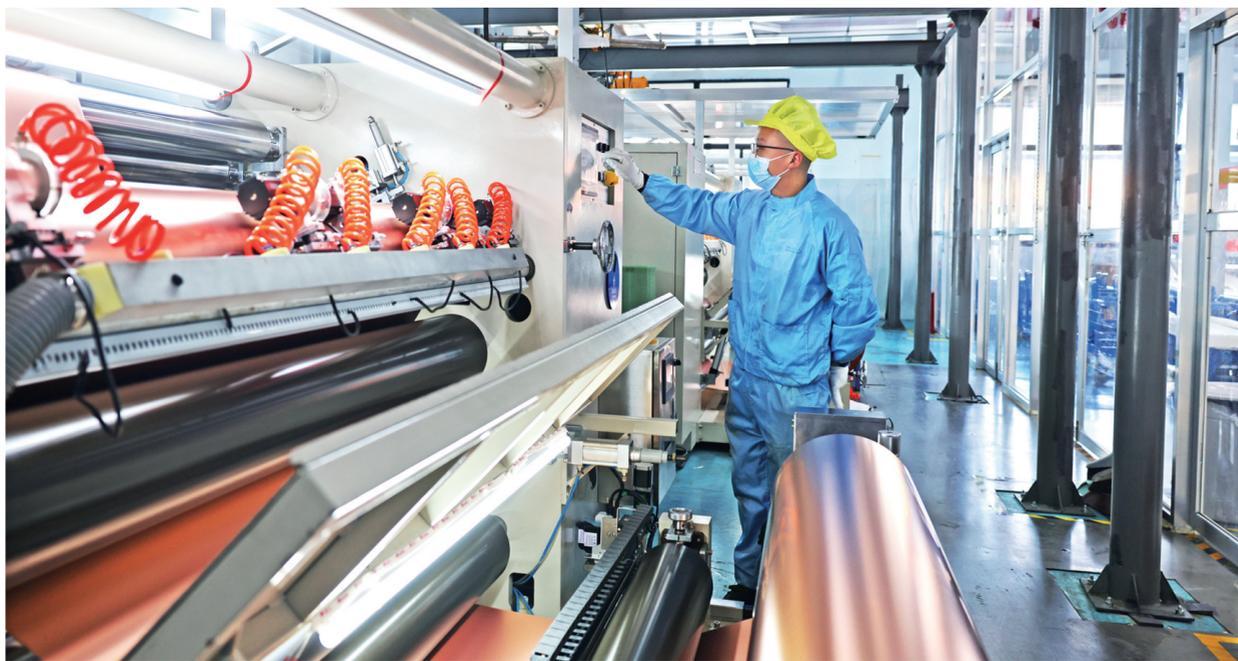
12月13日,山东嘉元新能源材料有限公司工作人员在操作高性能铜箔生产线。该公司采用高性能电解铜箔核心生产技术,研发出4.5微米厚的超薄铜箔,厚度相当于一根头发丝的十五分之一,属全国首创。
