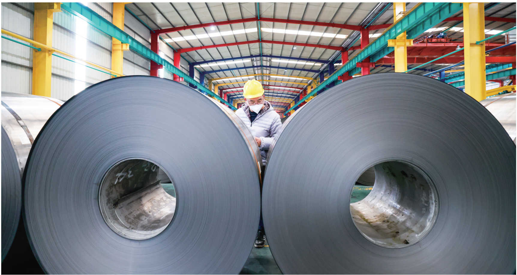
12月19日,工人在瑞丰复合材料有限公司检查记录热镀锌钢板等产品。瑞丰复合材料有限公司镀锌铝硅生产线项目引进具有国内一流水平的生产设备,采用特殊的生产工艺,产品表面光滑,具有优良的耐大气腐蚀能力,比同类型产品高2至6倍,具有良好的涂装性和加工性。 ■ 本报记者 商景豪
