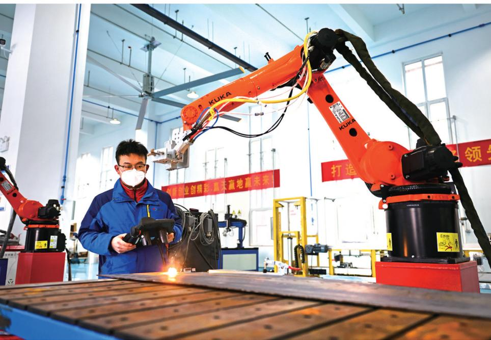
2月6日，高新区产研强远激光科技有限公司生产车间，工作人员在测试激光清洗设备。
