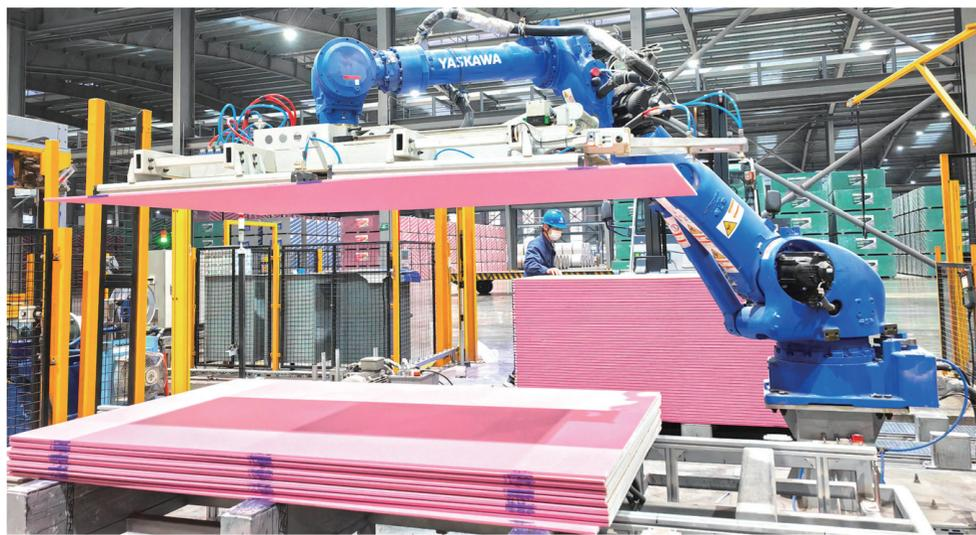
3月29日,在平区信源环保建材有限公司工人在智能生产线上生产石膏板。该公司石膏板项目采用先进工艺装备和智能变频技术,可实现全程自动化控制,年产纸面石膏板2.4亿平方米。
