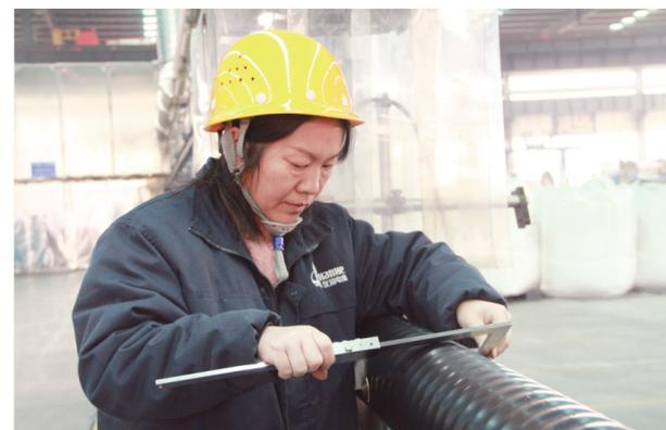
4月6日,在汉河(阳谷)电缆有限公司超高压及特种电缆项目生产车间,工作人员正在测量线缆护套外径。阳谷县通过“腾笼换鸟”,淘汰落后产能,引进汉河超高压及特种电缆项目,可年产110KV—500KV超高压交联电缆12000千米,有力推动了新旧动能转换。 ■ 本报记者 林金彦
