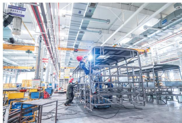
7月12日,在中通客车新能源汽车项目现场,工作人员正焊接车辆骨架。该项目总投资28.6亿元,主要生产新能源客车及氢燃料电池控制器、高压线束等产品,年可生产新能源客车3万辆。
