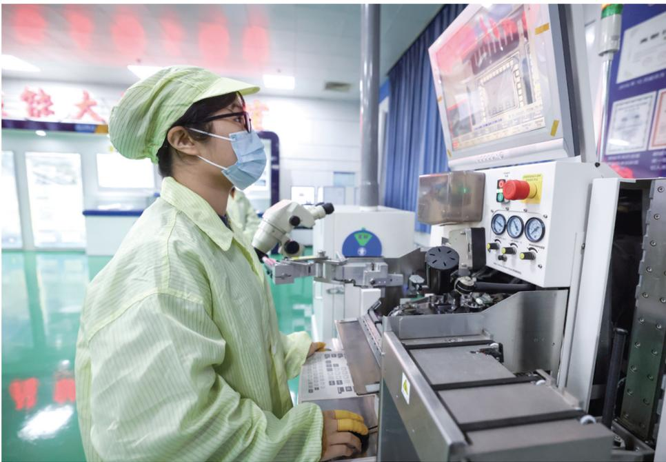
10月9日,山东太平洋光纤光缆有限公司工作人员使用金线焊机进行焊接作业。
