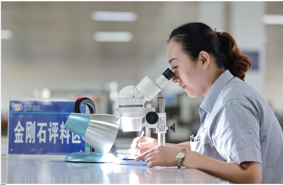
10月11日,山东昌润钻石股份有限公司工作人员在用显微镜对生产的金刚石进行质量分级。
