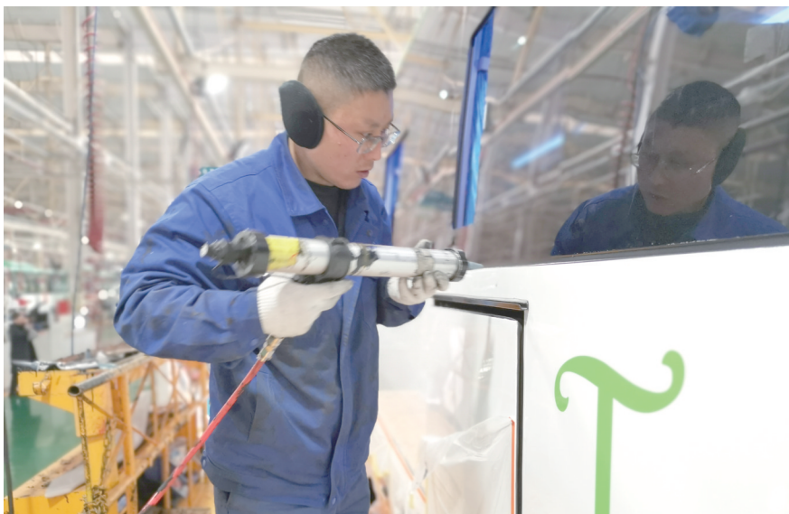
中通客车装配车间工人在车身粘贴流水条
