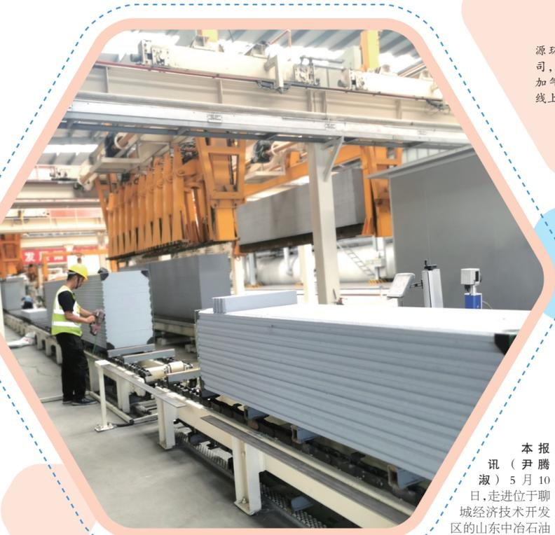
5月10日,在信源环保建材有限公司,工人们正在蒸压加气混凝土板生产线上忙碌着。
