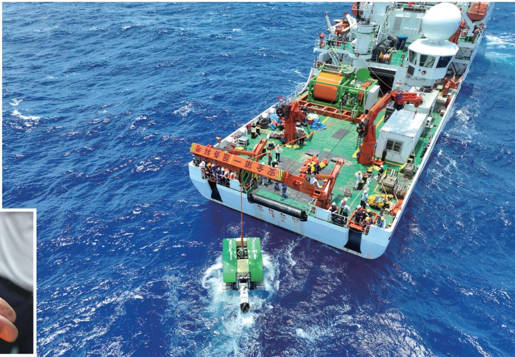
日前,我国深海矿产资源开发关键技术研究与装备研制取得重大突破,由上海交通大学自主研制的深海重载作业采矿工程样机“开拓二号”成功完成海试。“开拓二号”连续完成5次着底采矿,取回深海多金属结核与结核,实现深海重载作业采矿海试水深首次突破4000米,最深达4102.8米,在国内首创深海复杂海底地形高机动行进、深海多矿类复合钻采等深海采矿领域多项技术。
