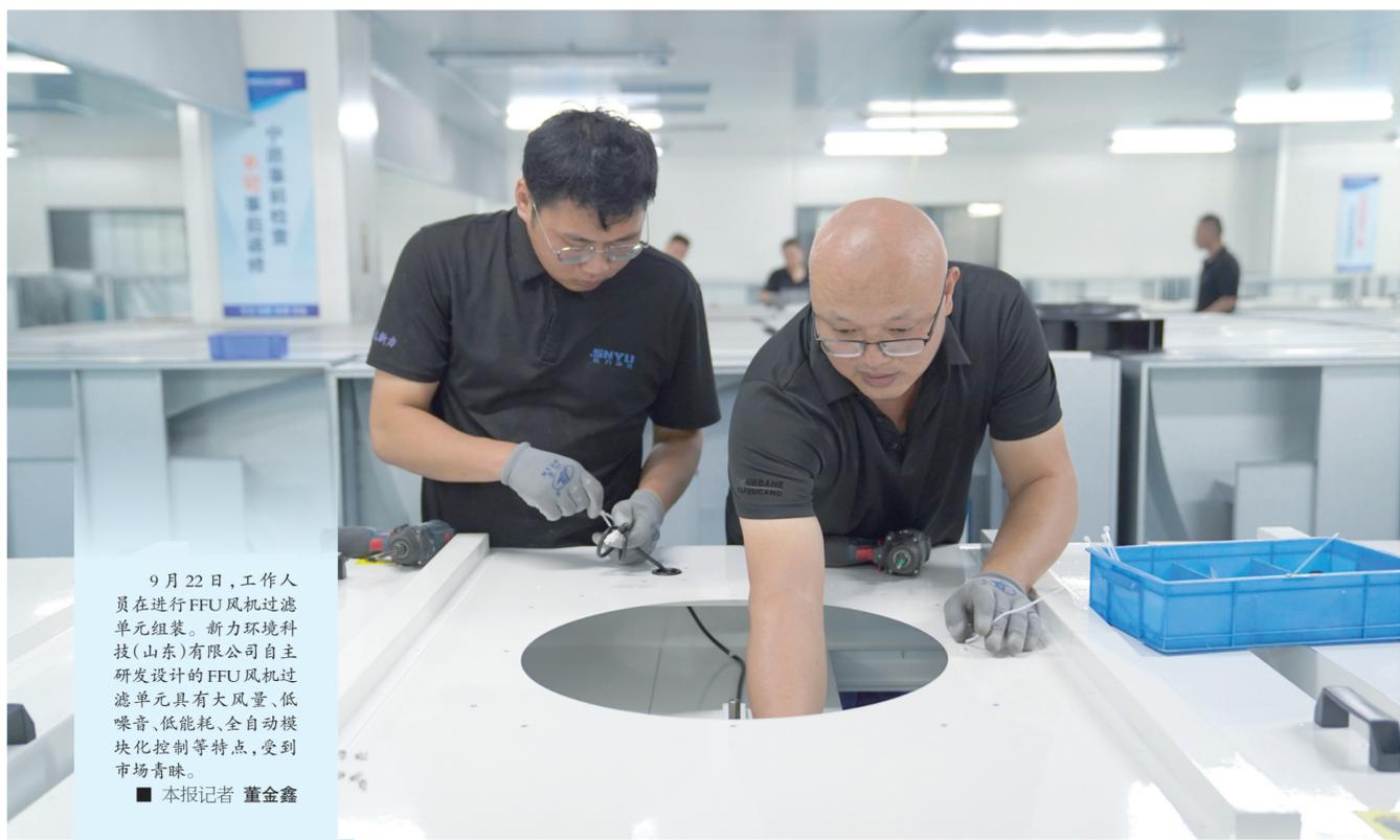
9月22日,工作人员在进行FFU风机过滤单元组装。新力环境科技(山东)有限公司自主研发设计的FFU风机过滤单元具有大风量、低噪音、低能耗、全自动模块化控制等特点,受到市场青睐。
