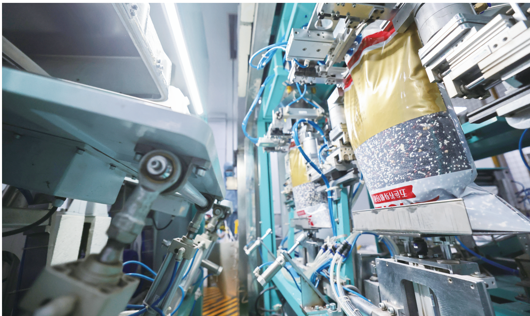
12月10日,在山东梦思香食品有限公司,全自动真空包装机进行粥类产品的包装。该公司生产的谷物代餐粉、风味汤类、全谷物粥、原产杂粮等健康产品辐射全国商超,成为行业标杆企业。近年来,我市持续提升食品供应链管理能力和数字化能力,从降本增效向实现价值创造转变,推动实现高质量、可持续发展目标。 ■ 本报记者 许金松
