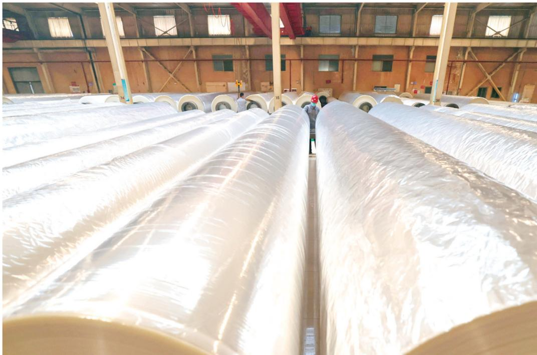
3月8日,在位于开发区的山东天震塑业有限公司内,工人对生产的塑料薄膜进行巡检。该公司主营产品BOPP薄膜无色、无味、无毒,具有高拉伸强度和良好的透明性,广泛应用于食品、医药、服装、电子、文具、日化等轻工领域产品的包装。
