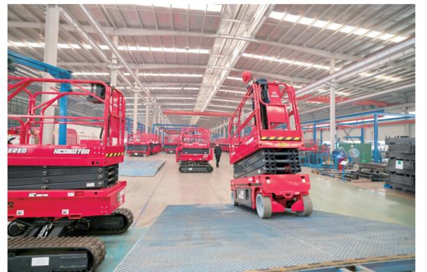
3月10日,赫锐德(山东)智能科技有限公司工人对生产的高空作业平台进行爬坡测试。该公司致力于高空作业平台设备研发、制造、销售及售后服务,采用数字双传感检测回路,实现了产品作业幅度、负载、高度的自动检测和精确控制。
