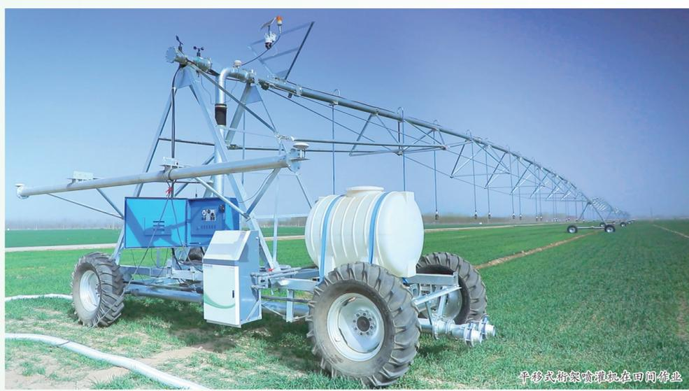
平移式桁架喷灌机在田间作业
