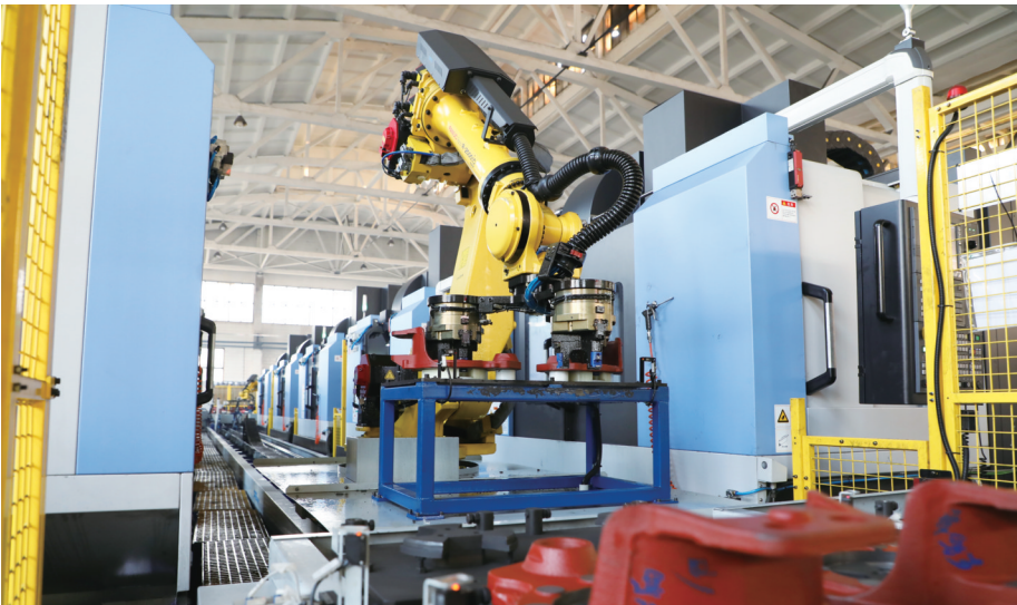
时风集团制动底板自动化生产线(受访单位提供)
