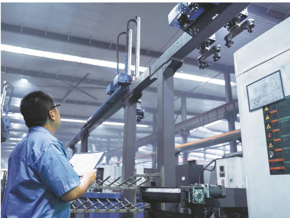
9月5日,在山东力得科技股份有限公司车间,工作人员正借助桁架技术与自动化机器人进行制动器精准加工。
