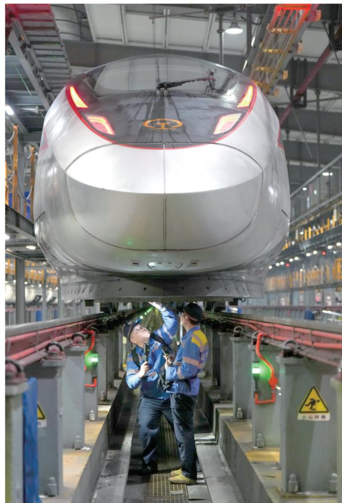
在中国铁路哈尔滨局集团有限公司哈尔滨动车段检修库，电务段信号工人对动车组ATP列车超速自动防护系统进行检测作业(1月31日摄)。
