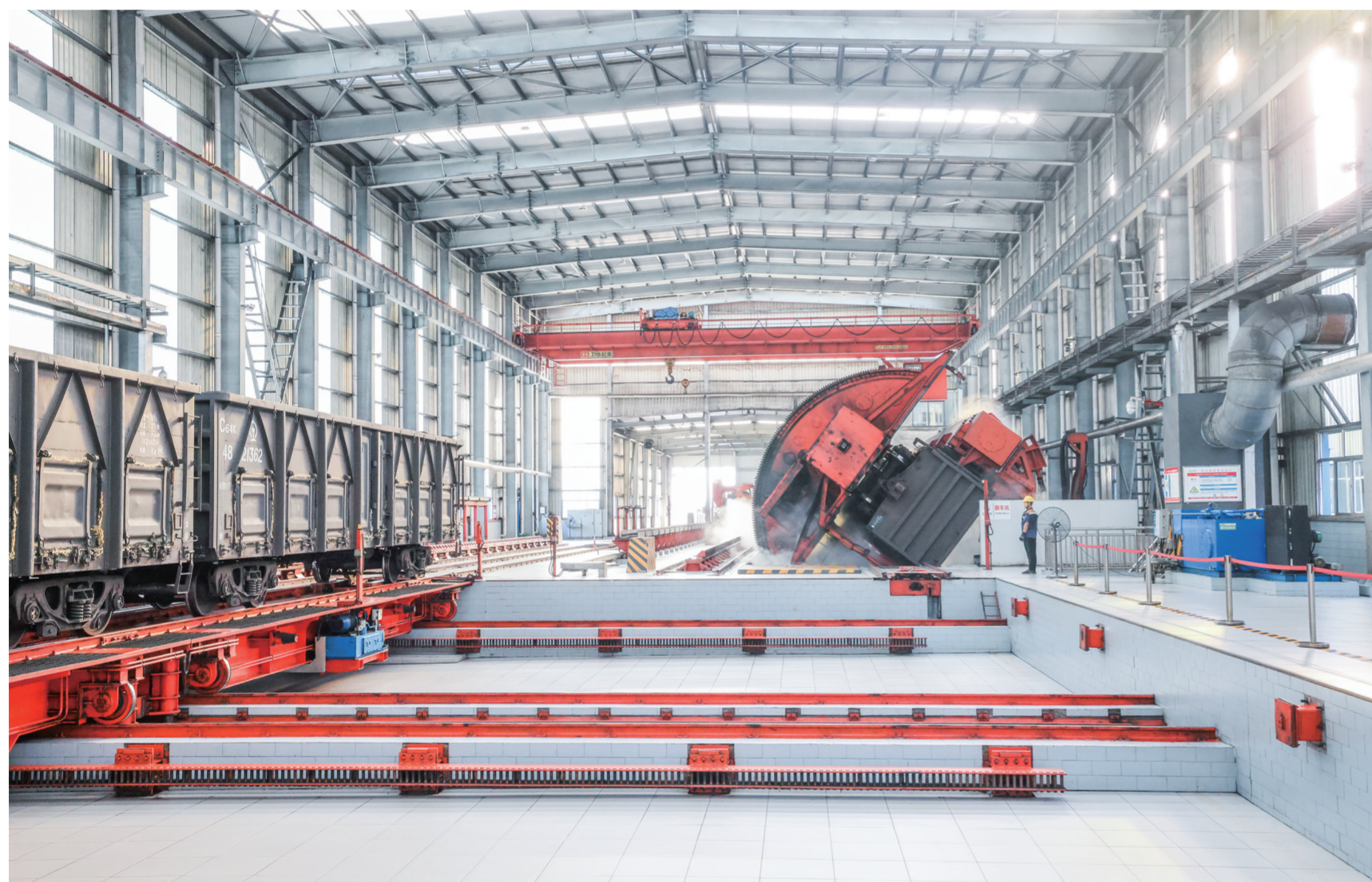
4月13日，信发集团卸煤车间，一节装满煤炭的火车在全自动装卸机的作用下缓缓向下翻转。该企业投资14亿元建成的煤炭铁路专用线，通过地下输煤系统将煤直接输送至锅炉，只需一名工人即可完成操作，不仅大大提高了效率，还全程没有扬尘。
